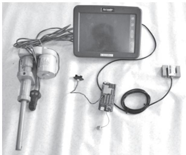
Рис. 2 – Общая схема системы дифференцированного внесения удобрений разбрасывателем
