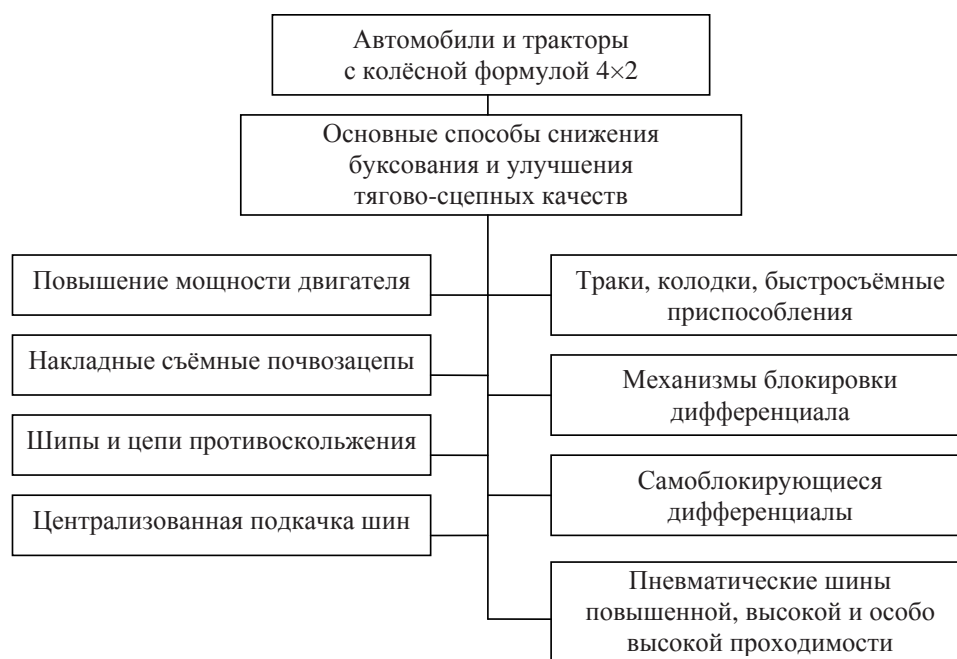
Рис. 1 – Основные способы и средства снижения буксования и улучшения тягово-сцепных качеств колёсных машин
