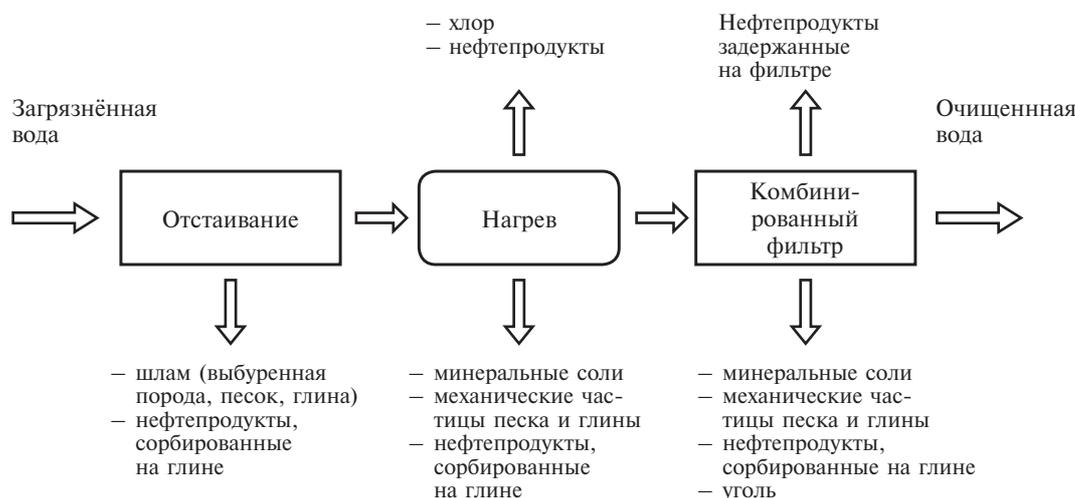
Рис. 6 – Технологическая схема № 3 с использованием комбинированного фильтра
