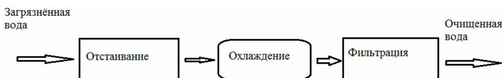
Рис. 2 – Технологическая схема № 2
