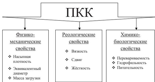
Рис. 2 – Подсистема подготовки кормовых компонентов
