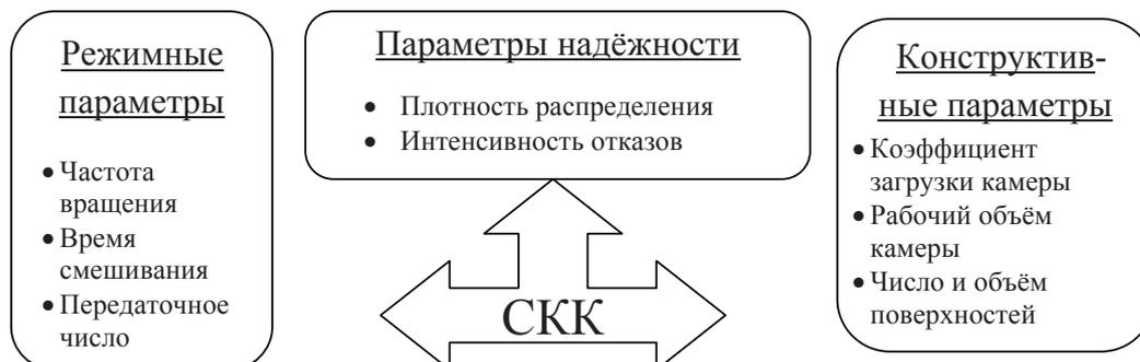
Рис. 4 – Подсистема смешивания кормовых компонентов
