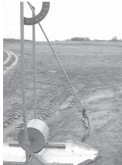
Рис. 4 – Проведение экспериментальных опытов по исследованию осыпаемости семян подсолнечника
