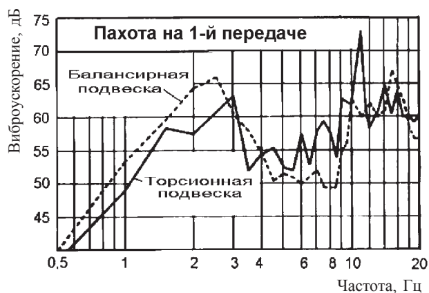
Рис. 3 – Логарифмические уровни вертикальных составляющих виброускорений пола кабины трактора во время пахоты со скоростью 6,5 км/час
