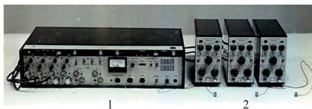
Рис. 2 – Аппаратура фирмы «Брюль и Кьер» для регистрации вибрационных сигналов: 1 – регистратор 7005; 2 – предусилители сигнала 2635
