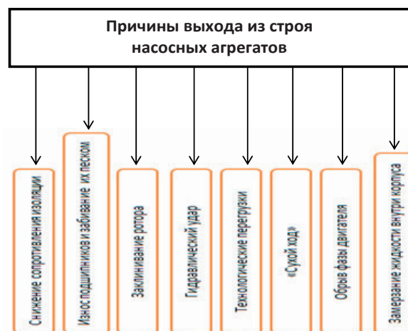
Рис. 2 – Причины выхода из строя насосных агрегатов
