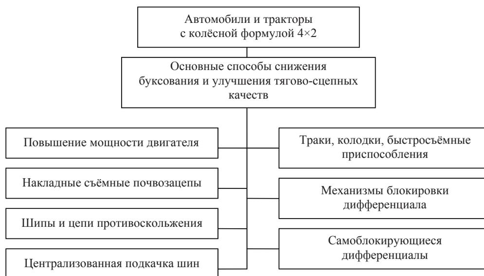
Рис. 1 – Основные способы и средства снижения буксования и улучшения тягово-сцепных качеств колёсных машин
