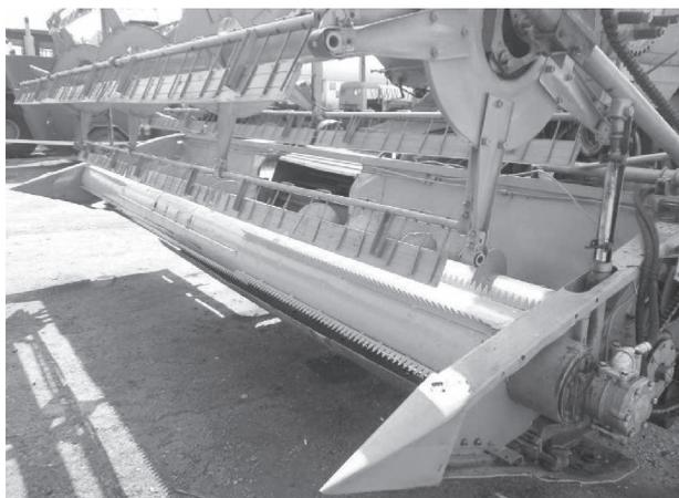
Рис. 1 – Адаптер (барaban с зубчатым очёсывающим устройством к жатке для уборки зерновых методом очёса)
