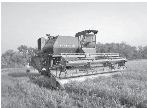
Рис. 2 – Комбайн на уборке яровой пшеницы с жаткой для очёса колоса
