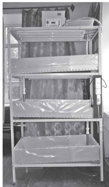
Рис. 3 – Опытная гидропонная установка для выращивания зелёной кормовой массы [7]
