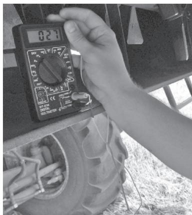
Рис. 2 – Измерение температуры барабана измельчающего барабана
