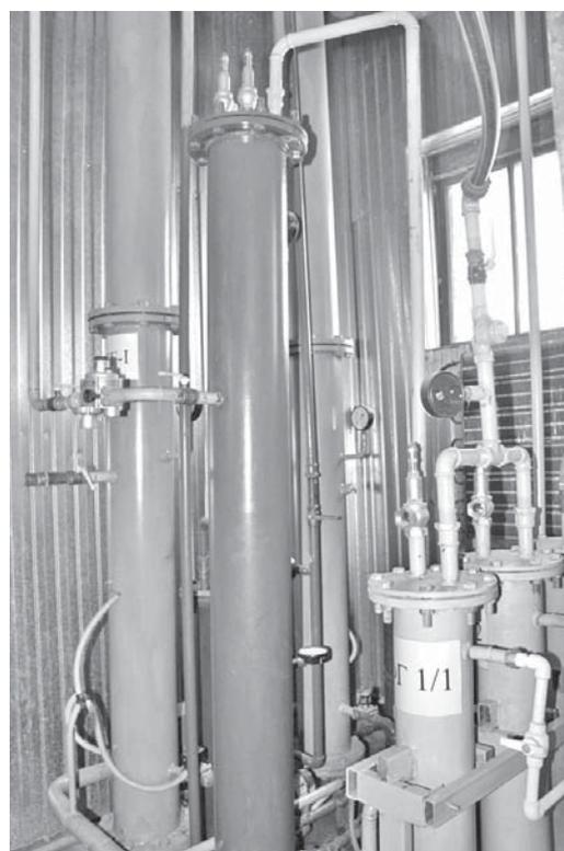
Рис. 2 – Регенеративная водяная система обогащения биометана, п. Самородово
