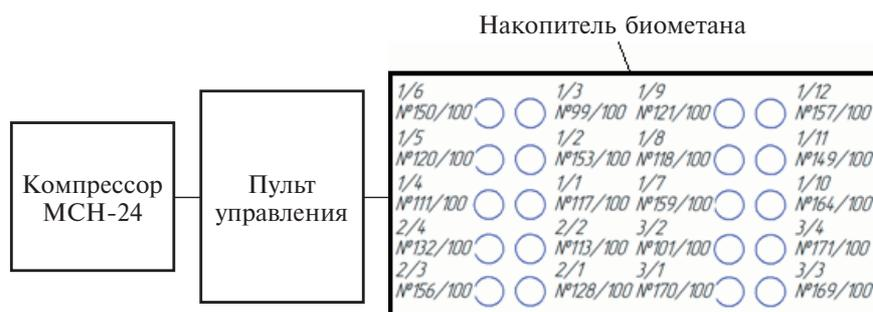
Рис. 3 – Схема биогазового заправочного пункта в п. Самородово
