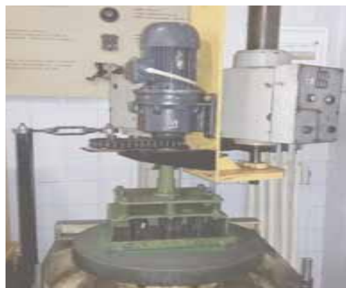
Рис. 4 – Схема доводочного станка: 1 – станина; 2 – притир; 3 – кассетница; 4 – эксцентрик; 5 – крепление эксцентрика; 6 – мотор-редуктор; 7 – подвижная опора; 8 – ведущая звёздочка цепной передачи; 9 – неподвижная опора; 10 – шатун; 11 – ведомая звёздочка цепной передачи; 12 – палец крепления шатуна с эксцентриком; 13 – компенсирующий механизм
