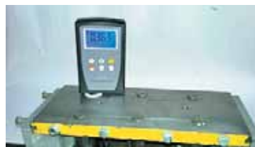
Рис. 3 – Измерение шероховатости уплотнительного торца корпуса форсунок
