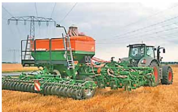
Рис. 3 – Сеялка DMC Primera шириной захвата от 3 до 12 м
