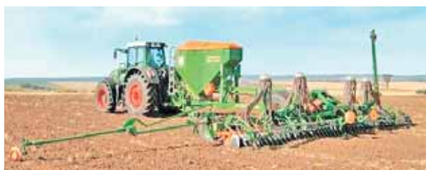
Рис. 2 – Сеялка Citan шириной захвата от 9 до 15 м
