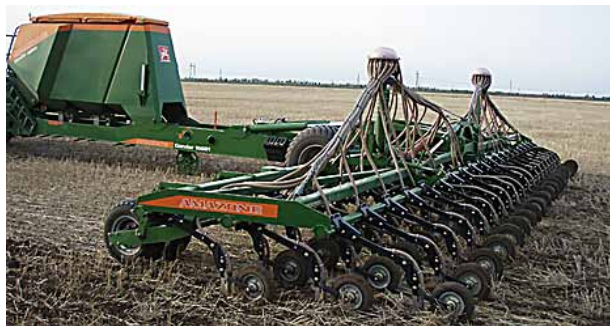
Рис. 4 – Сеялка прямого посева Condor шириной захвата от 12 до 15 м
