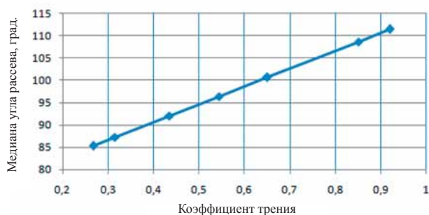
Рис. 2 – Зависимость медианы угла рассева от коэффициента трения рассеиваемого материала
