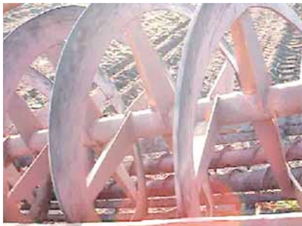
Рис. 1 – Шнеково-вальцовый очиститель вороха корнеплодов в составе комбайна
