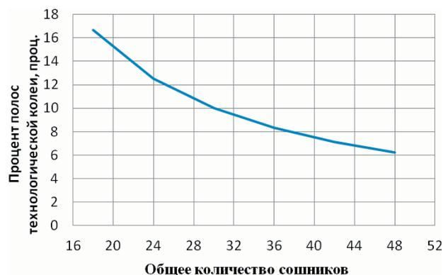
Рис. 3 – Зависимость процента полос технологической колеи от количества высеваящих аппаратов сеялки
