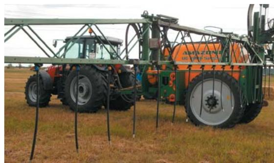
Рис. 3 – Штанги Super-S и навесные шланги на опрыскивателе AMAZONEN
