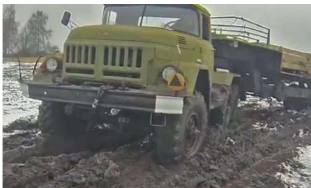
Рис. 2 – Поворот грузового автомобиля на поверхности с малой несущей способностью при возникновении момента сил, противодействующего повороту
