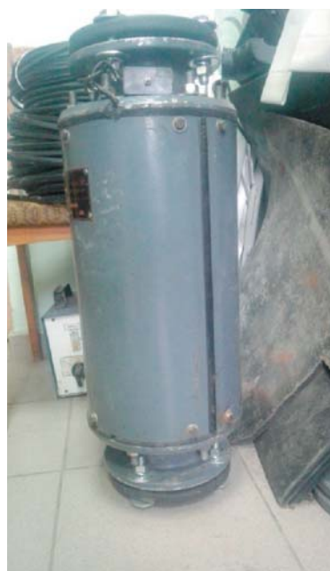
Рис. 1 – Электромагнитный фильтр с наполнителем из ферромагнитных шаров
