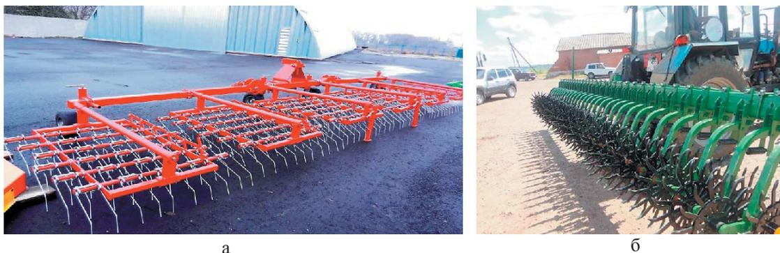
Рис. 1 – Современный комплекс машин для боронования посевов:
