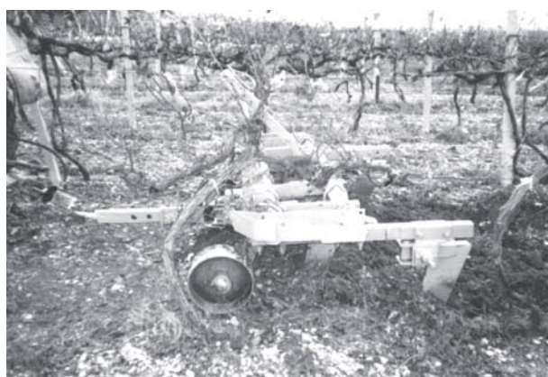
Рис. 2 – Культиватор для обработки междурядий виноградников с виброударными рабочими органами
