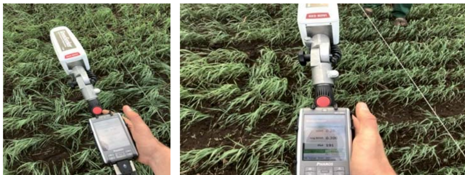
Рис. 4 – Датчик системы GreenSeeker RT 200 с полевым компьютером
