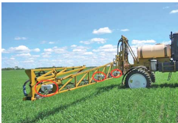
Рис. 2 – Опрыскиватель, оснащённый системой Green Seeker
