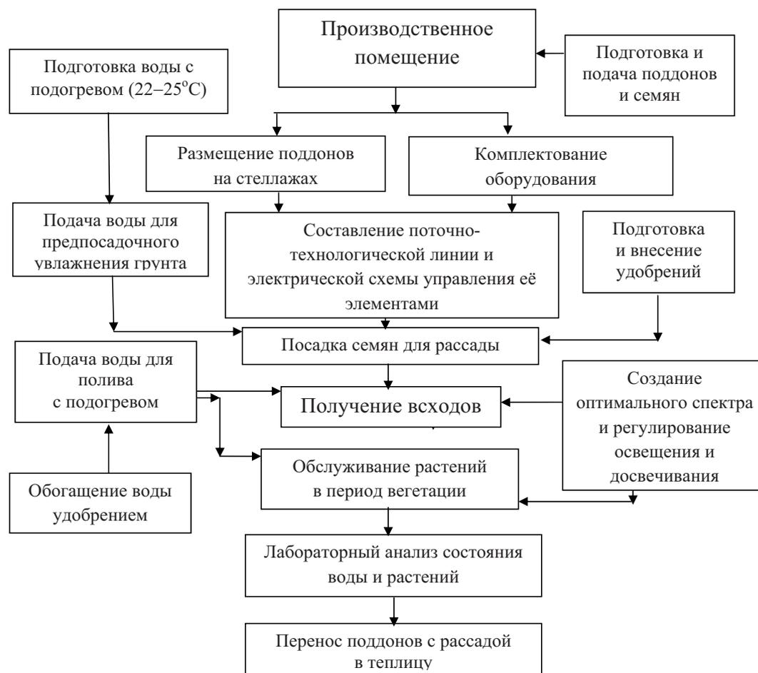
Рис. 1 – Схема поточно-технологической линии выращивания рассады с досвечиванием для массового производства
