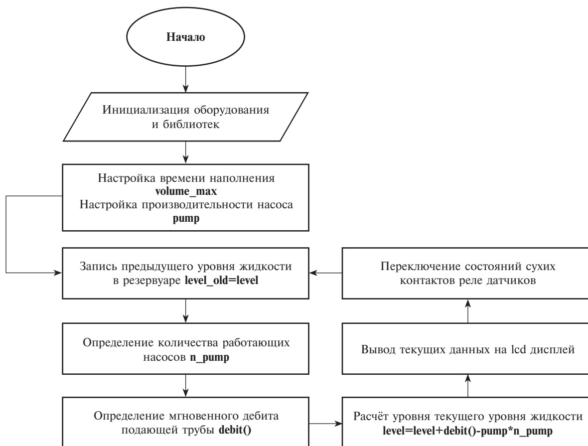
Рис. 3 – Алгоритм работы микроконтроллера физической модели насосной станции
