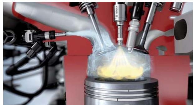
Рис. 2 – Непосредственный впрыск водо-метанола в двигатель [4, 5]
