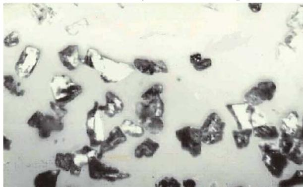
Рис. 3 – Микроструктура порошка карбида кремния в светлом поле (увеличено в 500 раз)
