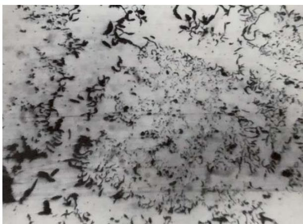
Рис. 3 – Микроструктура чугуна зоны лазерного воздействия (увеличено в 360 раз)
