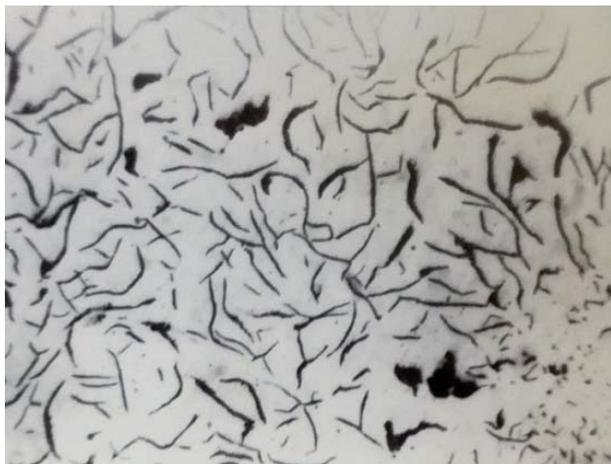
Рис. 2 – Микроструктура чугунной детали (увеличено в 360 раз)
