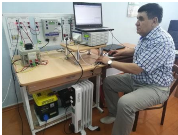
Рис. 1 – Моделирование бесперебойности электроснабжения сельских потребителей на экспериментальной установке
