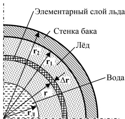
Рис. 2 – К расчёту температурного сопротивления бака
