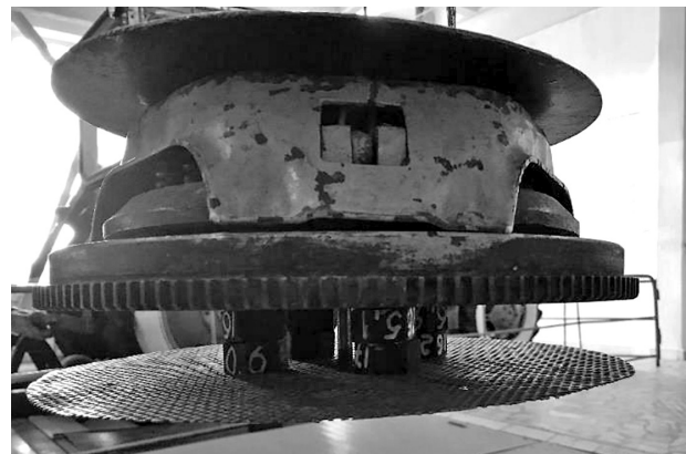
Рис. 3 – Маховик с переменным моментом инерции (грузы расположены на минимальном радиусе)
