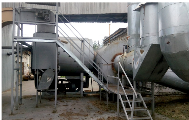
Рис. 1 – Участок подключения теплогенератора к сушилке в ООО «Заводоуковский масло-завод» (Тюменская область, Россия)
