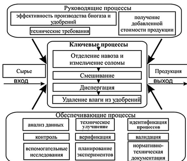
Рис. 4. – Карта процессов биогазовой установки
