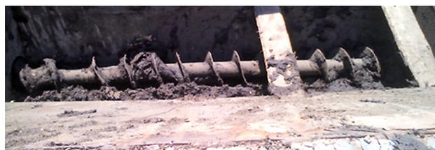
Рис. 1 – Загрузочный бункер с приемным шнеком
