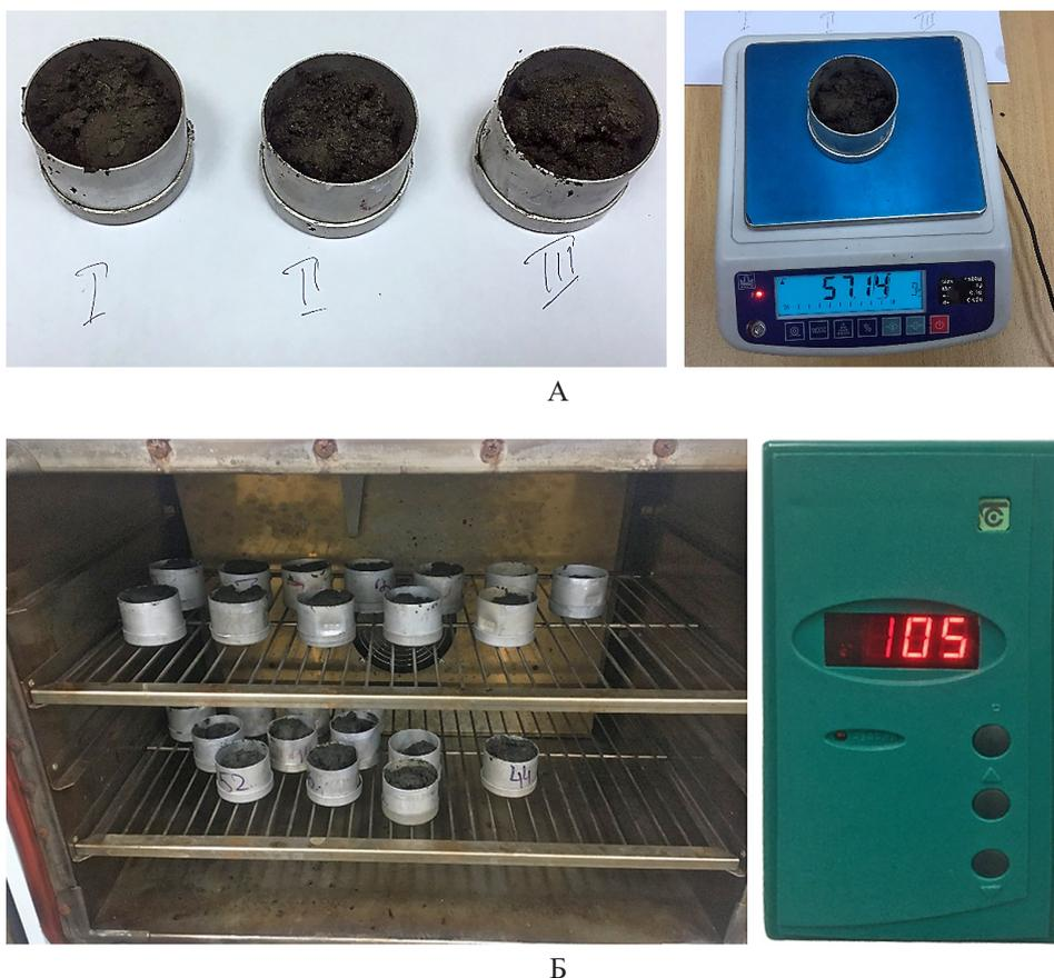
Рис. 1 – Лабораторный опыт термической сушки сапропеля: А – исследуемые образцы; Б – сушильный шкаф
