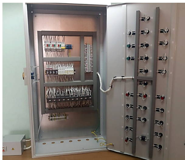
Рис. 2 – Внешний вид щита управления технологическим оборудованием, применяемым в АПК
