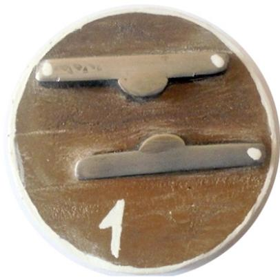
Рис. 2 – Подготовленные микрошлифы, наплавленные плазменным способом порошками с разным содержанием карбида вольфрама, запрессованные в эпоксидную смолу
