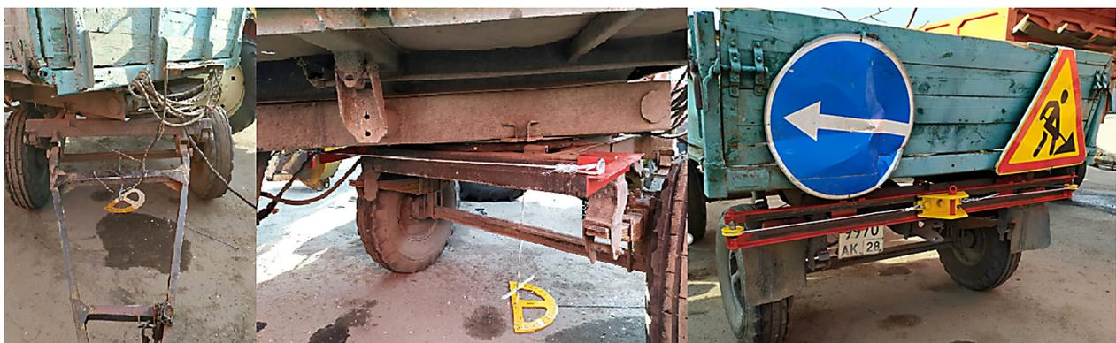
Рис. 2 – Устройство для смещения точки сцепления первого звена (прицепа) и второго звена (прицепа)
