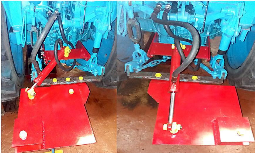
Рис. 1 – Устройство для смещения точки сцепления трактора и первого звена (прицепа)
