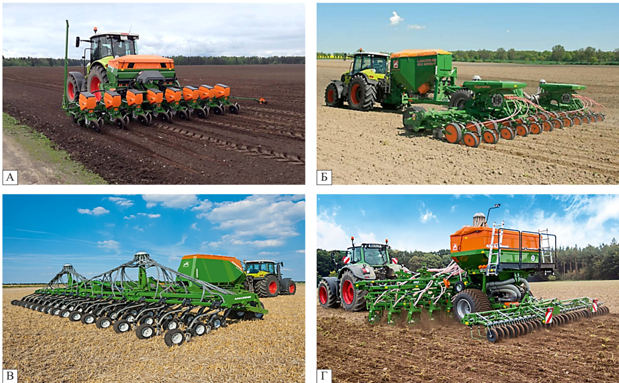
Рис. 5 – Сеялки для пропашных культур – подсолнечника, кукурузы: А – ED, Б – EDX; зерновые сеялки, исследуемые на посеве подсолнечника: В – Condor (междурядья – 25 см), Г – EDX (междурядья – 18,5 см)
