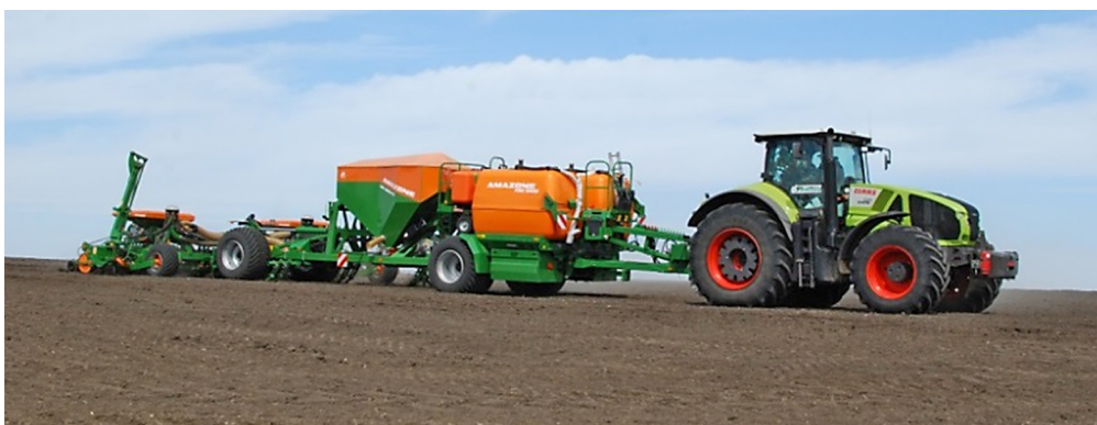
Рис. 7 – Комбинированный агрегат FDC-6000 с сеялкой EDX-9000 для посева подсолнечника с внесением КАС
