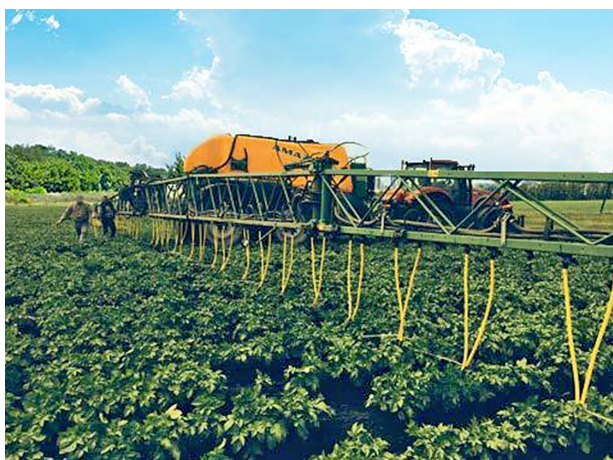
Рис. 1 – Опрыскиватель AMAZONEN (АО «Евротехника») с удлинительными шлангами для прикорневой подкормки пропашных культур КАС
