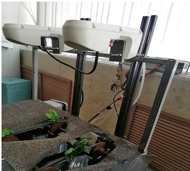
Рис. 3 – Настройка датчика WeedSeeker по высоте
