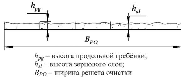
Рис. 2 – Поперечное сечение зернового слоя на решете (верхнее)
