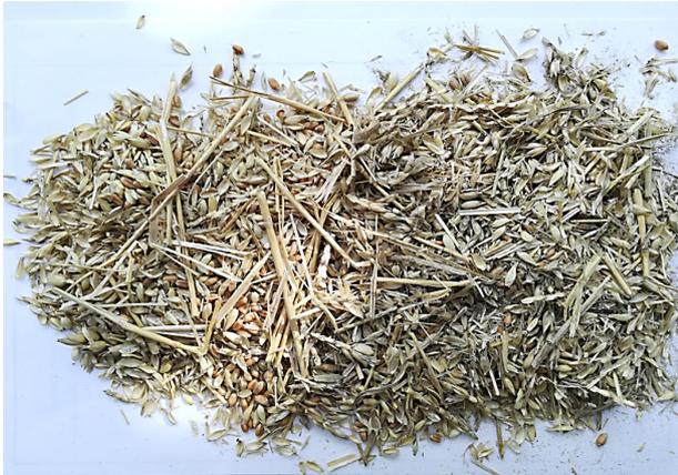
Рис. 1 – Зерновой ворох, поступающий на решёта системы очистки зерноуборочного комбайна
